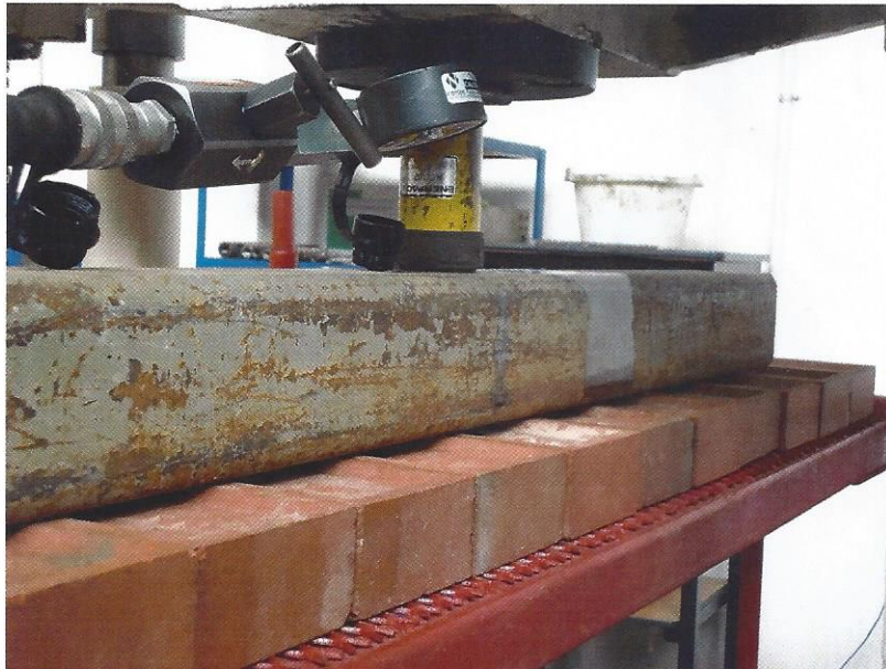
Foto 6 Ensayo de Carga distribuida sobre plataforma 1500 mm x 300mm.
