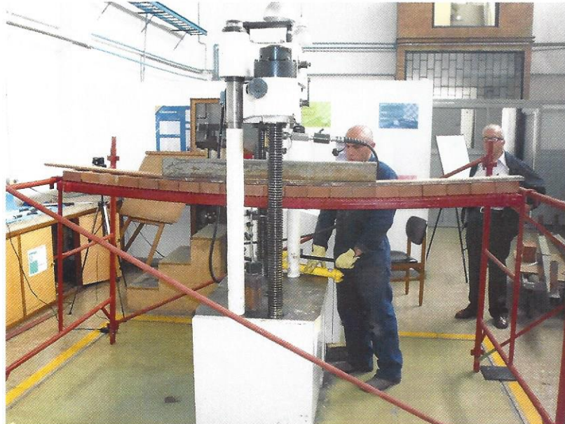
Foto 4 Ensayo de Carga distribuida sobre plataforma 2650 mm x 300mm.
